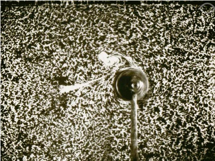
Abb. 2.3: Aufnahmen eines rotierenden Zylinders im Wasserkanal des KWI, die wahrscheinlich mit der Liesegang gemacht wurden.
