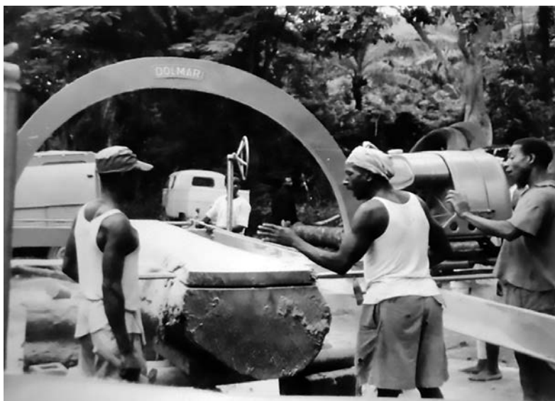
Abb. 3: Die neu angelieferte Dolmar-Säge zum Sägen harter Teak-Baumstämme in Agou, handschriftlich ist »Bohlen und Balken sägen« daneben vermerkt. Im Hintergrund ist ein im Rahmen des Projekts aus Deutschland gelieferter VW T2 Pritschenausführung zu erkennen. Mai 1963, BArch Koblenz B213 04111.
