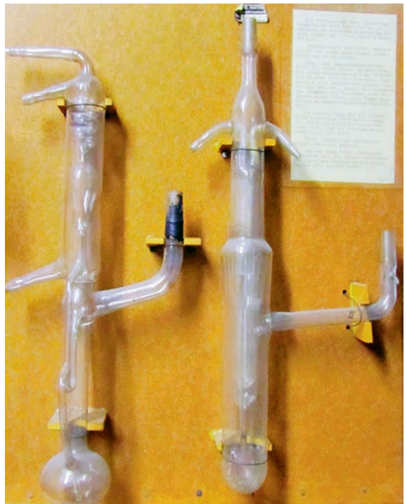
Historische Vakuumpumpen des Stern-Gerlach-Versuchs Links: Volmer'sche Diffusionspumpe, rechts: Gaede-Pumpe
